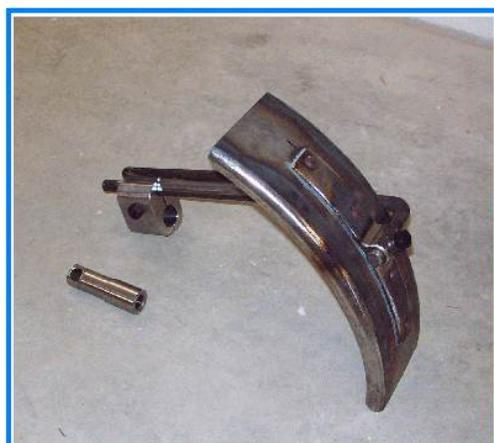
01.02.02) 1,00 Stk ED16II Kotflügelhalter für Bergische Achse links oder rechts
