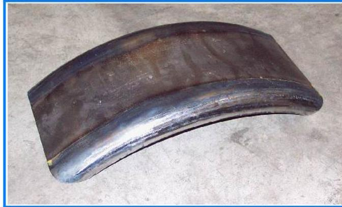
05.01.02) 1,00 Stk Fendt F24 Kotflügel hinten kompl. Deckblech mit Seitenteil aus 1,5mm schw. Blech
