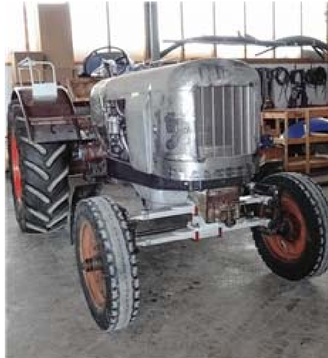
FOTOS CA Probemontage der restaurierten Blechteile.
