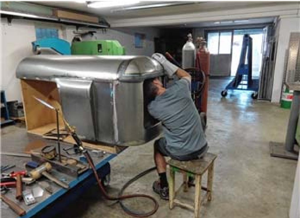
Originalgetreue Neuanfertigung von Blechteilen für Oldtimer-Traktoren.
